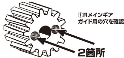
②ドリル加工用の穴にドリルを差しネジを仮締めしガタを取り、芯出した後にネジを本締めして下さい。
